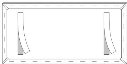
**CZ 3b. Montáž pomocí suchého zipu**
